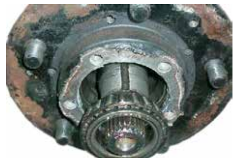
Kegellager nach dem Ausbau
