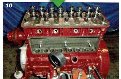
Der Zylinderkopf ist geplant, mit neuen Ventilführungen und Schaftabdichtungen versehen. Eine Umrüstung auf Bleifreibetrieb ist selbstverständlich. Die Schrauben werden in einer vorgeschriebenen Reihenfolge und Drehmoment angezogen.
