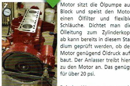
Motor sitzt die Ölpumpe au-Block und speist den Motor einen Ölfilter und flexible Schläuche. Dichtet man die Ölleitung zum Zylinderkopf ab kann bereits in diesem Stadium geprüft werden, ob der Motor genügend Öldruck aufbaut. Der Anlasser treibt hierzu den Motor an. Das genügt für über 20 psi.
