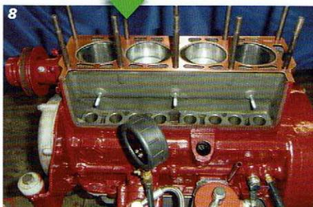
Stehbolzen montiert und die Zylinderkopfdichtung passt.
