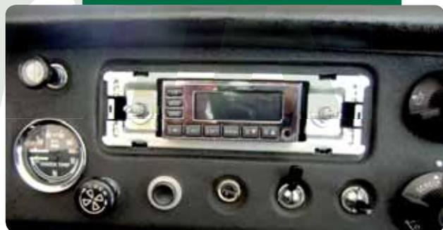
Alles zusammen versprach einen spannenden Einbau. Das Radio passt mit einem universalen Einbausatz in die vorhandene Öffnung.
